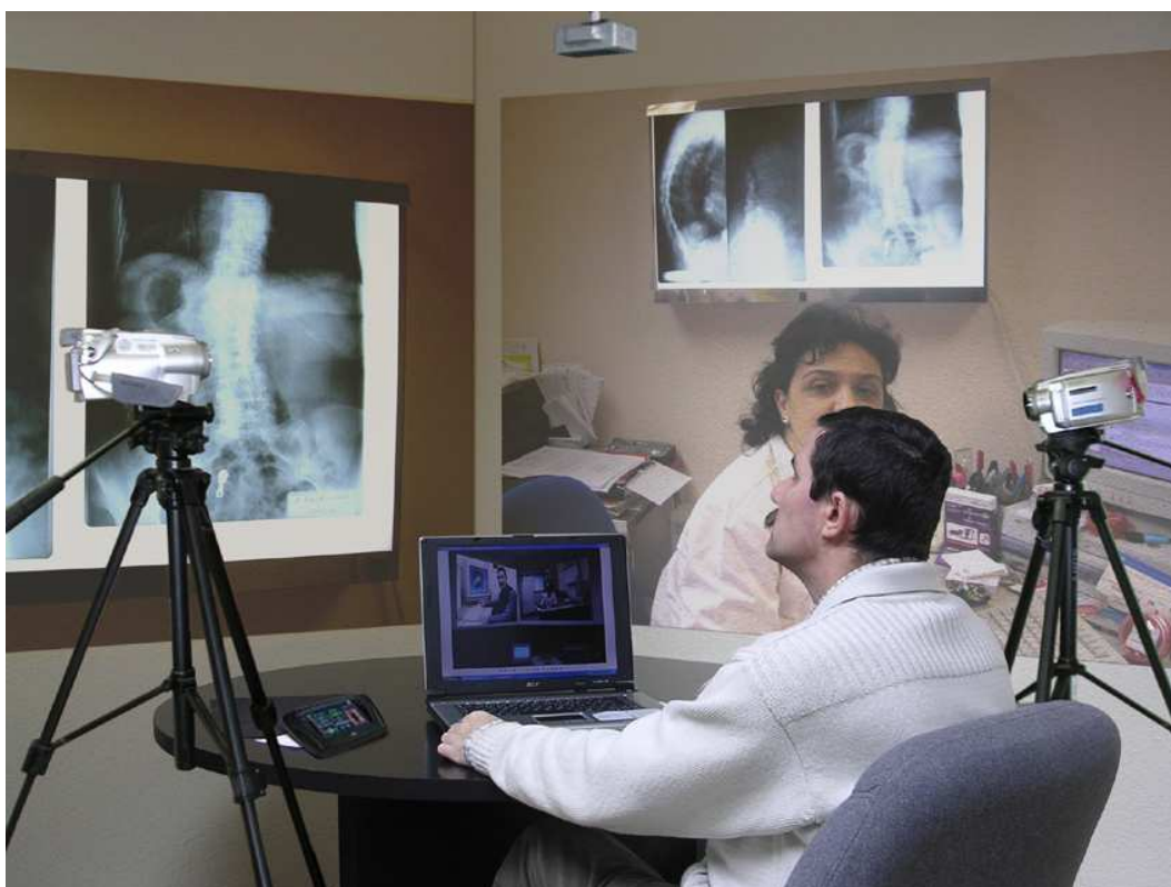
Elementos que integran un sistema teleinmersivo de comunicación a distancia: conjunto de cámaras digitales, telemetro láser, cañón de proyección.
