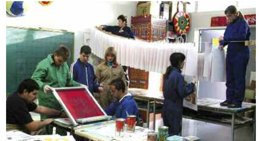
Este grupo de alumnos y alumnas, trabajando en equipo, efectúa el proceso de impresión en serigrafía del calendario: preparando las cartulinas en blanco, imprimiendo con la pantalla, sacando las hojas impresas, transportándolas y colocando las copias en un tendedor para su secado
