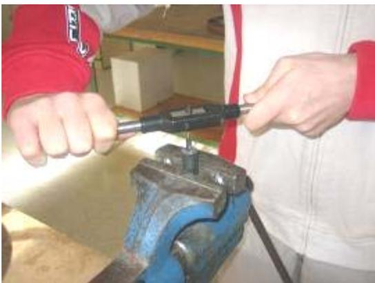
Una vez agujereado el redondo de 11mm de diámetro, con una broca de 5,1mm (si no hay se puede hacer con la del 5,5mm), se introducen los tres machos de M6 consecutivamente, para realizar el roscado interior.
