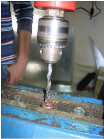
En el tape de cobre se realiza un agujero de 6mm de diámetro para unir el tubo de 15mm, que hace de tambor, con el tornillo.
