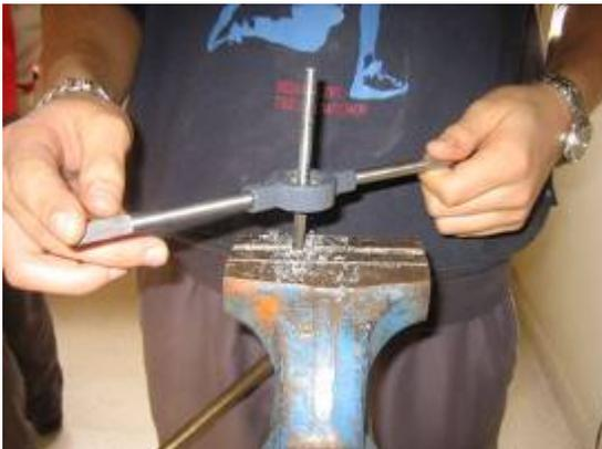
Con la ayuda de una terraja de M6, se realiza el roscado exterior de la varilla de 6mm de diámetro.
