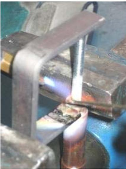
Se calienta la unión con el soplete de butano y oxígeno y se introduce la varilla del metal de aportación, en este caso de plata.
