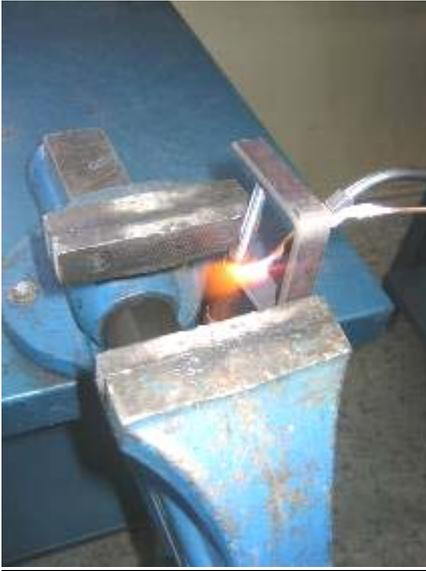
La forma de unir el tubo de cobre interior con el cuerpo de hierro es con soldadura heterogénea fuerte.
