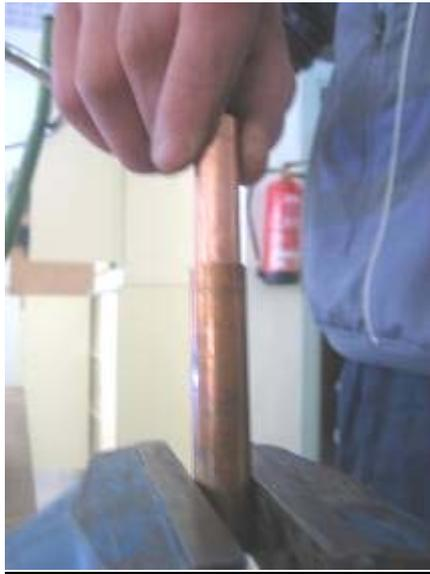
Una vez cortados los tubos, se comprueba como el tubo de  $\frac{1}{2}$ " se introduce perfectamente en el de 15mm.
