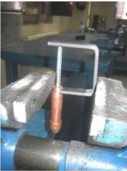
Se coloca el conjunto en el tornillo de banco para soldar el tubo interior con el cuerpo.
