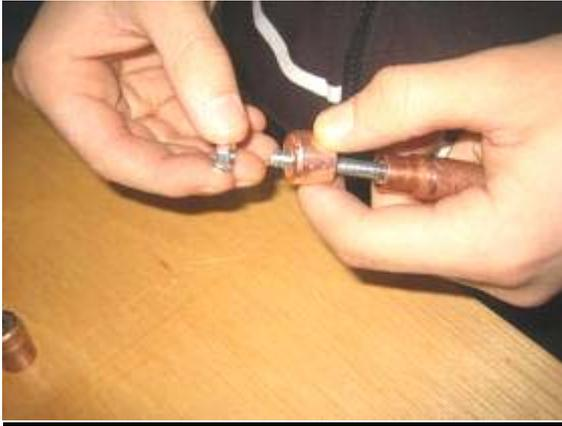
En un extremo del tubo de 1/2" se introduce el redondo de 11mm con la tuerca realizada en él de M6.
