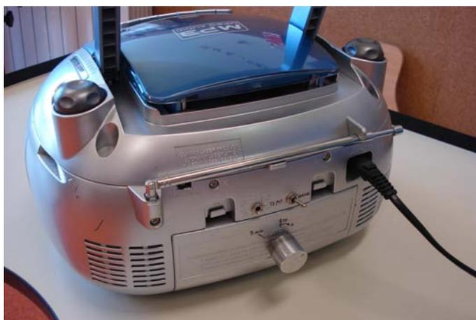
Radiocaset adaptado para su uso por parte de alumnos con dificultades de acceso. Lleva incorporado un temporizador, lo que permite que el profesor pueda programarlo de forma muy sencilla a través de una ruleta para que la música se detenga con la frecuencia deseada, por ejemplo, cada 10 segundos. Para que la música continúe, el alumno debe pulsar su conmutador y activar de nuevo el electrodoméstico.
