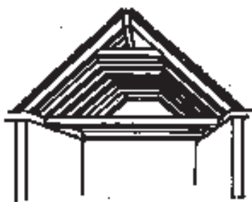
armadura de par y nudillo
